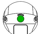
Napájanie ON čerpadlo OFF
